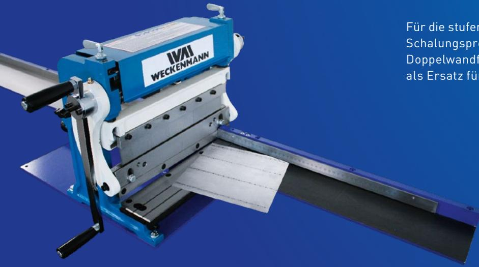
Für die stufenlose Längenanpassung von Schalungsprofilen bei der Elementdecken- und Doppelwandfertigung mit Magnetbefestigung als Ersatz für Styroporprofile.
