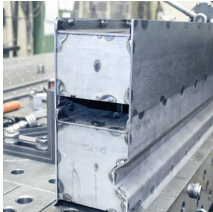
Die M-BASIS / M-TOP-Serie besteht aus einer Basisschalung mit integrierten schaltbaren Magneten und Aufsatzprofilen im Baukastensystem. Durch den Einsatz von Aufsatzprofilen (M-TOP) lassen sich die Schalungshöhen individuell anpassen.
