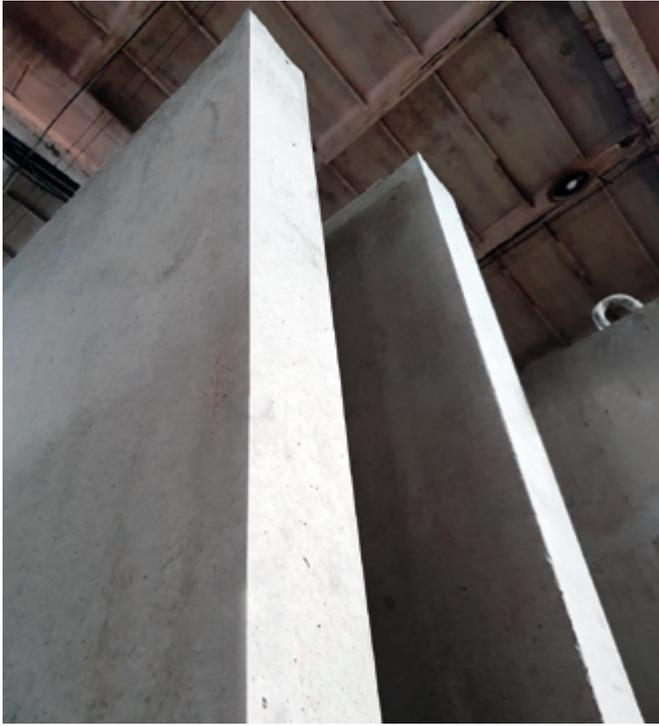
*Weckenmann a donc développé une variante semi-mobile du système de coffrage en batterie avec des propriétés statiques améliorées, dans laquelle sont produits tous les éléments préfabriqués requis pour un immeuble, y compris les dalles pleines d'une épaisseur de 180-200 mm.*
