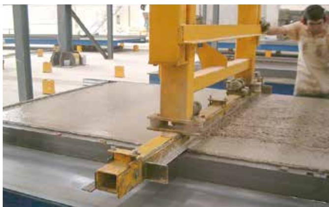
également adapté au retrait automatique de la surface de l'élément préfabriqué
