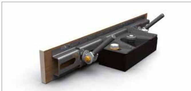
Le système de fixation aimanté pour planches de coffrage en bois pour la fabrication de divers produits selon les spécifications individuelles des clients. X-UNI est composé d'un adaptateur de vissage universel combiné à des aimants commutables et des tendeurs excentriques sans outils.
