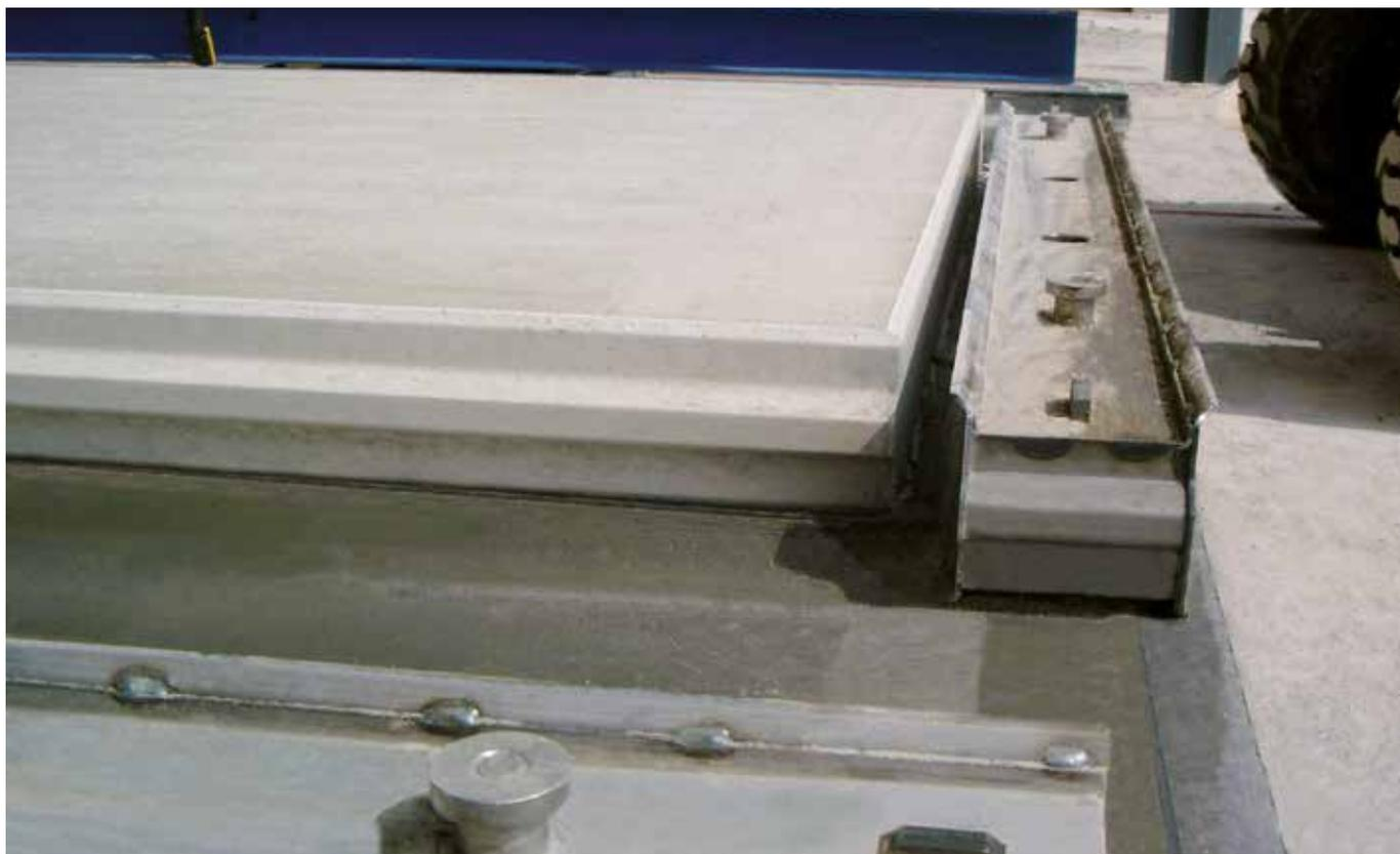
lors de la fabrication d'un élément de mur massif avec formation de chanfreins et joints de coulis
